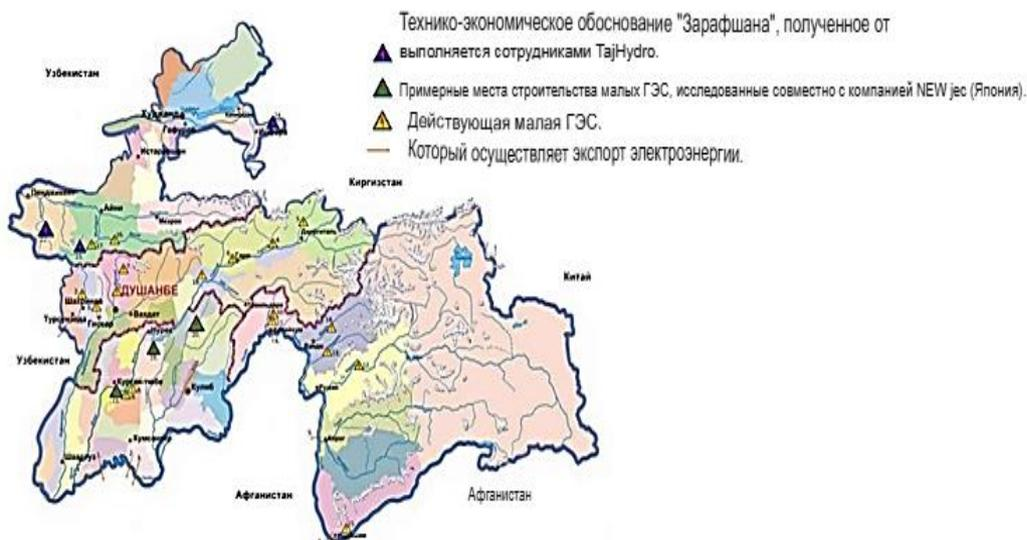
Рисунок 2 – Карта рек и водохранилищ Республики Таджикистан с обозначением потенциальных мест размещения малых гидроэлектростанций
